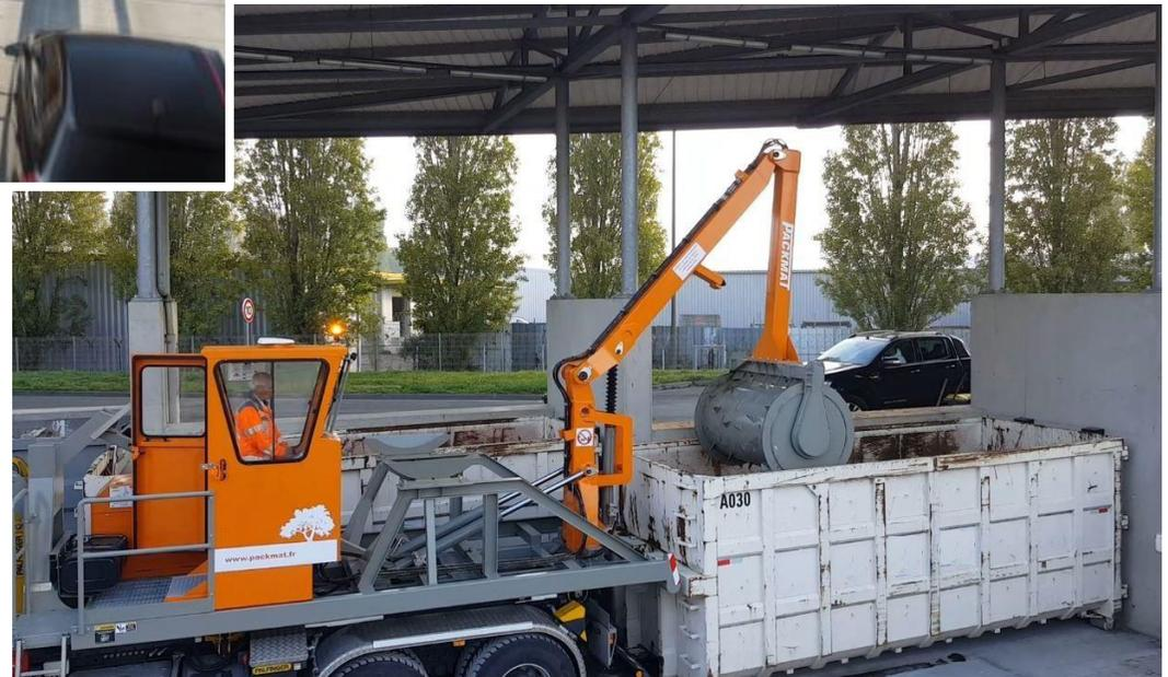
Verdichtung der Containerinhalte vor Ort durch Rollpacker, um geringe Füllmengen zu vermeiden.
