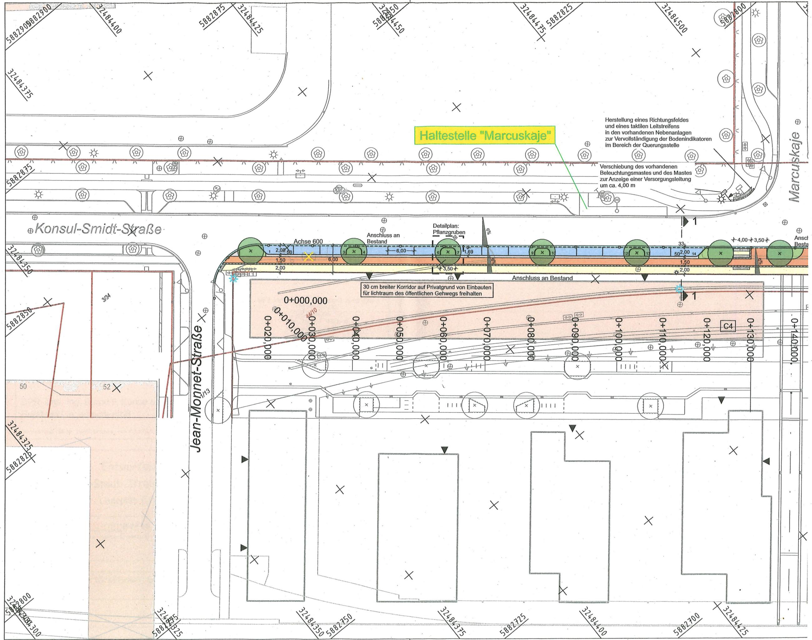
Herstellung eines Richtungsfeldes und eines taktilen Leitstreifens in den vorhandenen Nebenanlagen zur Vervollständigung der Bodenindikatoren im Bereich der Querungsstelle
