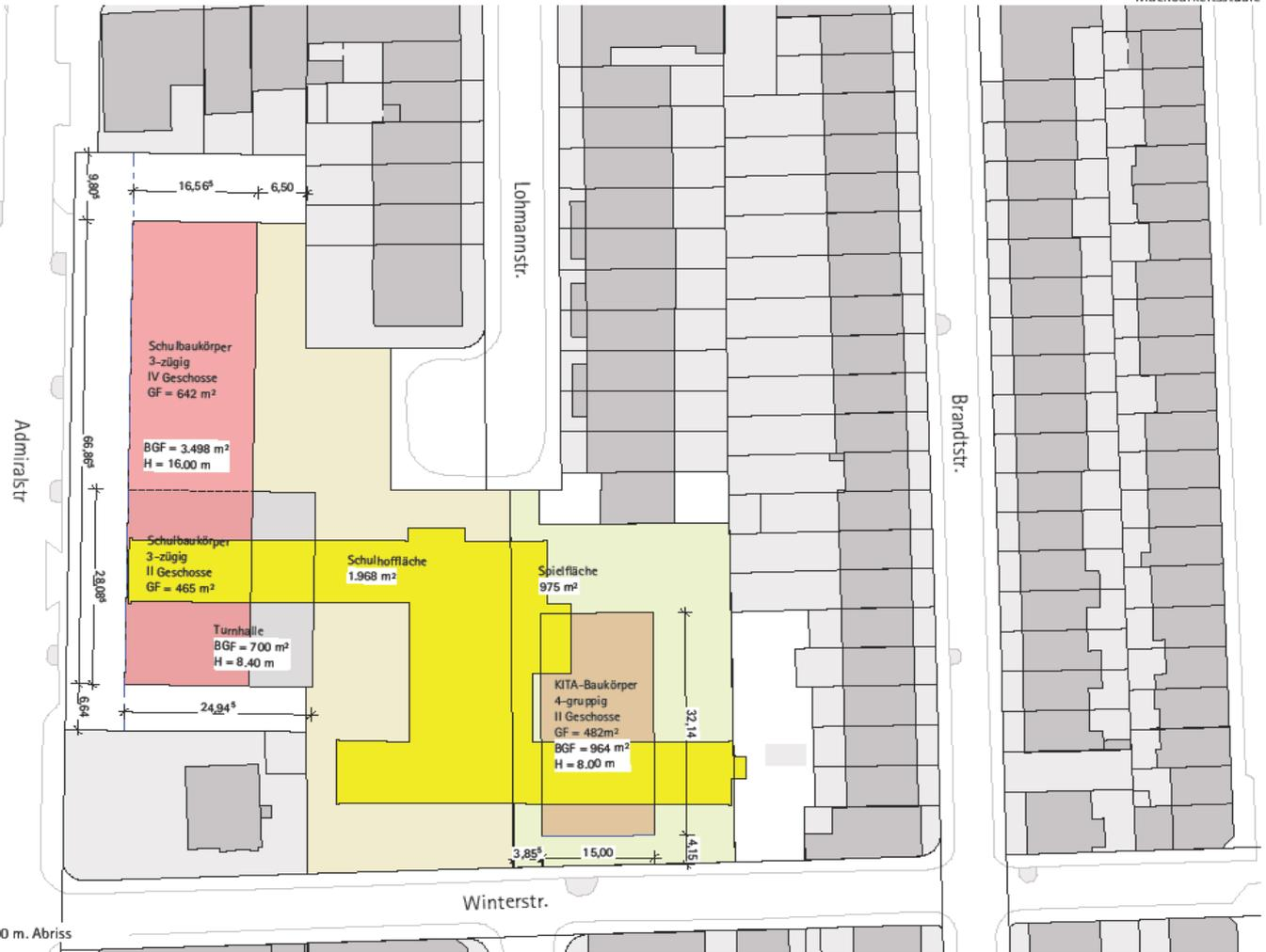
NEUBAU VARIANTE 1 LAGEPLAN M 1:500 m. Abriss
