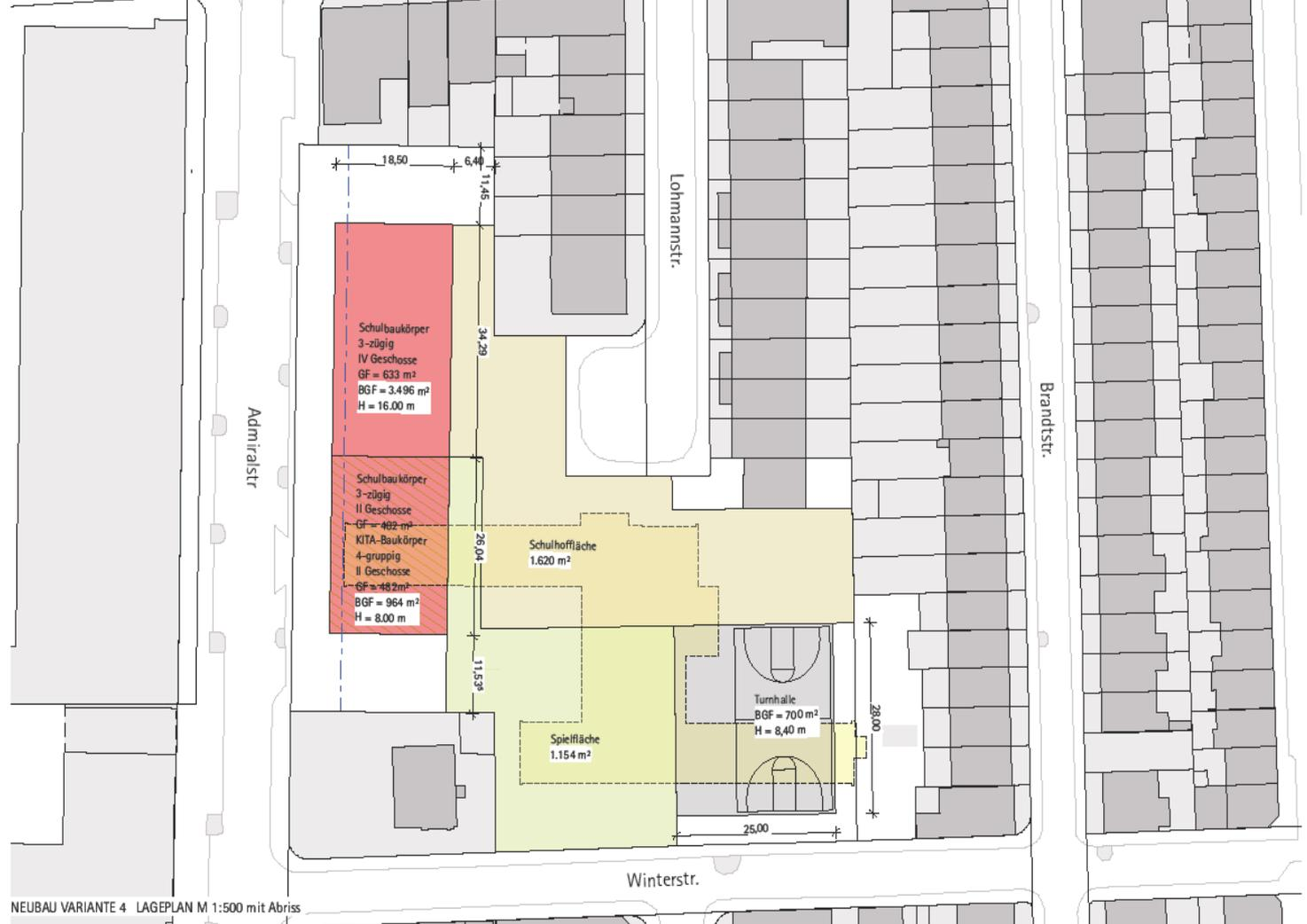
NEUBAU VARIANTE 4 LAGEPLAN M 1:500 mit Abriss
