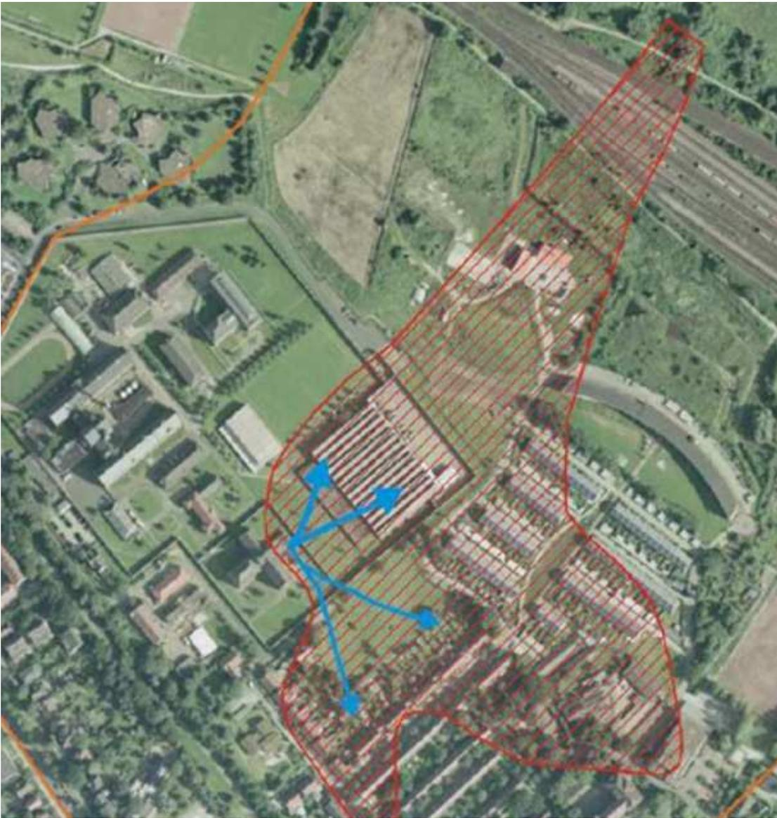
Abb. 12: Verteilung der Verunreinigung im oberen Grundwasserleiter (schraffierter Bereich), Einwurf Haushalte, Referat: Altlasten und schädliche Bodenveränderungen
